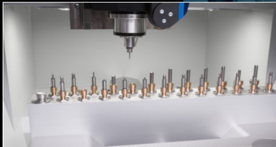
24-fach Werkzeugmagazin mit integriertem Längensensor
