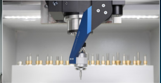
3D Messtaster (XYZ-Sensor) und Kamera
