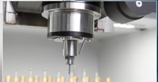
2 kW Spindel und Minimalmengen-Kühlschmiersystem
