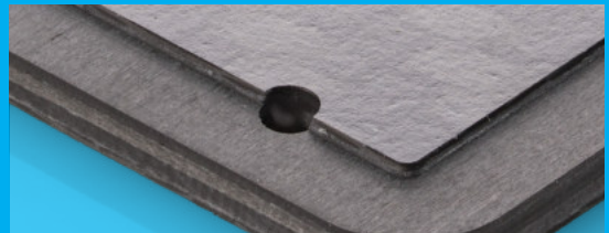
Konturen, Bohrungen und Taschen ohne Ausfasern in CFK/GFK
