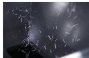
Steile Winkel an allen schrägen Flächen und ein Späneförderer sorgen für einen **zuverlässigen Abtransport der Späne**.
