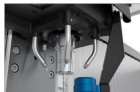
Zuverlässige und rückstandsfreie Kühl schmierung während der Bearbeitung bei geringem Verbrauch.
