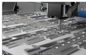
**Große Arbeitsfläche** ideal für das Fräsen von im Nutzen kombinierten Bauteilen.
