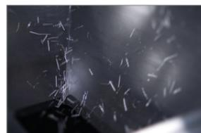
Steile Winkel an allen schrägen Flächen und ein Späneförderer sorgen für einen zuverlässigen Abtransport der Späne.
