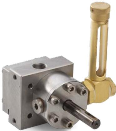
Hochgenaue, beheizbare Zahnradpumpe aus hochchromlegiertem korrosionsbeständigem Stahl für alle gängigen Schmelzklebstoffe und reaktiven Schmelzklebstoffe. Durch ihren speziellen Aufbau arbeitet sie leise und pulsationsarm in einem großen Drehzahlbereich.
