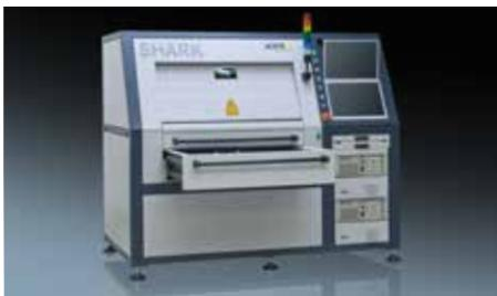
**5. SHARK Dual Lasersystem.** Zwei Galvoköpfe und zwei Laserquellen zum gleichzeitigen Bearbeiten der Werkstücke von zwei Seiten. Schubladensystem zur hauptzeitparallelen Be- und Entladung. (QR-Code zum Film, siehe rechts)
