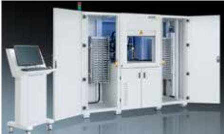
**1. PIRANHA Multishift – Automation mit Palettenbestückung.** Die Anlage kann mit bis zu 20 Paletten auf einmal beladen werden. Das OPR – Optische Teileerkennung erfasst die Position und Lage (Rotation) der Bauteile und arbeitet die Palette selbsttätig ab. (QR-Code zum Film, siehe rechts)
