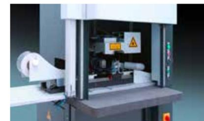
**4. PIRANHA mit Folienhandling.** Lasersystem arbeitet im vollautomatischen Betrieb. Die Firmeninterne Datenbankanbindung ermöglicht eine effektive und fehlerfreie Seriennummern und/oder Code-Einspeisung. Die Laserbearbeitung erfolgt in einem Arbeitsgang mit dem Ausschneiden der gewünschten aSchilderform und ermöglicht somit die Erstellung eines Schildersatzes. (QR-Code zum Film, siehe rechts)
