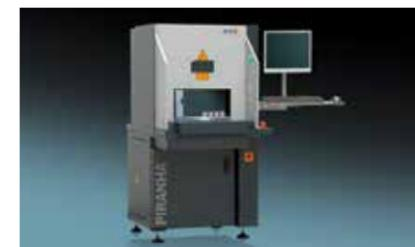
**3. PIRANHA Rundtisch "Quadro".** Das System ermöglicht die Bearbeitung von vier Rundteilen am Umfang in einem Arbeitsgang. Der Rundtisch bietet dem Anwender die Möglichkeit die Anlage hauptzeitparallel zu be- und entladen. Der NC gesteuerte, integrierte "Quadro" Teilapparat von ACSYS maximiert die Produktivität bei der Bearbeitung von Rundteilen am Umfang. (QR-Code zum Film, siehe rechts)
