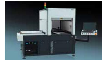
**2. PIRANHA Doppellaser & Automation.** Im Automatikmodus werden vorkonfektionierte Paletten auf das vordere der beiden Laufbänder gelegt, und automatisch nacheinander in die Maschine gezogen. Die Bauteile werden zeitgleich von oben und unten mit zwei separaten Laserquellen markiert. (QR-Code zum Film, siehe rechts)
