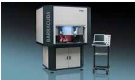
**4. BARRACUDA OPR - Vollautomation mit Robotik-Greifern** für palettierte Aufgaben. Zwei Robotik-Greifer, ein Rundtisch mit zwei integrierten Teilapparaten, zwei verfahrbare Palettenträger und das OPR von ACSYS für die vollautomatische Abarbeitung verschiedenster Werkstücke.
