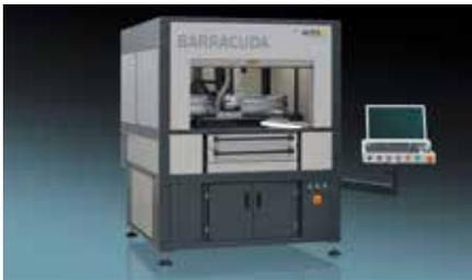
**2. BARRACUDA Schubladenlösung mit OPR.** Die Bauteile werden lose in die Schubladen eingelegt. Das integrierte Kamerasystem (OPR - Optische Teileerkennung mit automatischer Abarbeitung) erkennt die Bauteile in Lage und Position, und beschriftet sie im Anschluß selbsttätig.
