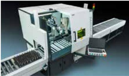
**1. BARRACUDA mit Palettenezuführung und Robotik.** Die Werkstücke werden palettiert auf die linke Rollenzuführung gelegt. Das Lasersystem befördert die Paletten in die Anlage wo die Werkstücke vollautomatisch abgearbeitet werden.
